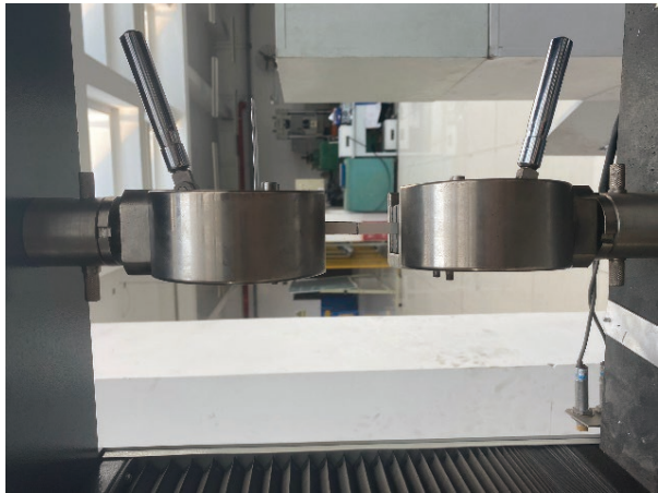
图 5 3 种微粒不同质量分数改性处理的拉剪试验
