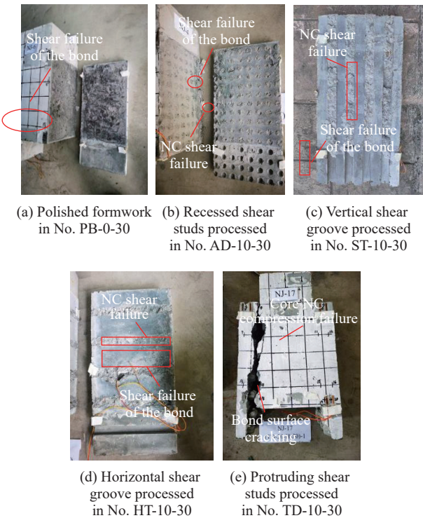
图6 超高性能混凝土-普通混凝土 (UHPC-NC) 黏结试件典型破坏形态 Fig. 6 Typical failure mode of UHPC-NC specimens
