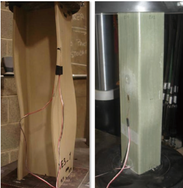
图7 工字形和箱形截面拉挤型材柱件局部屈曲 [31-32] Fig. 7 Local buckling of PFRP I- and Box-columns [31-32]
