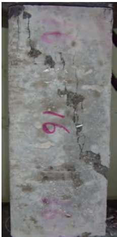
图8 SFRLAC试块典型破坏图 Fig. 8 Failure patterns of SFRLAC specimen
