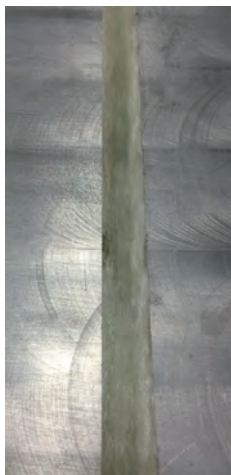
图9 自动铺放成型 GF/PP 复合材料平板构件
