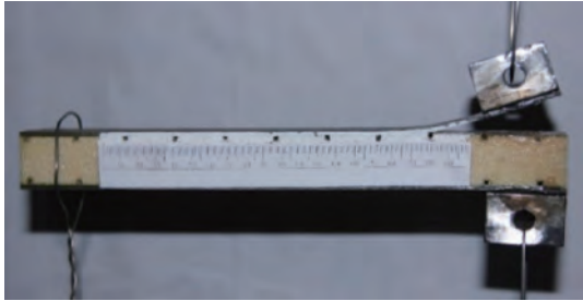
图 6 加筋增强泡沫夹芯板双悬臂梁试验装置
