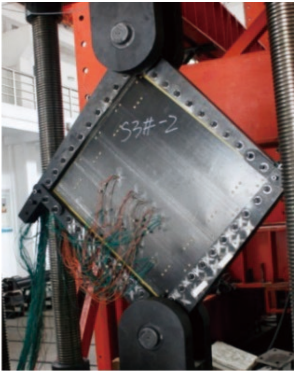
图 11 剪切试验夹具现场图 [67]
