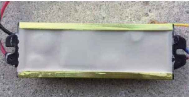
图 3 装了灌封胶的 LED 驱动电源 Fig. 3 LED drive power containing encapsulant
