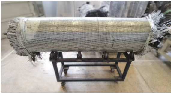
图 11 爆破后的储氢瓶
