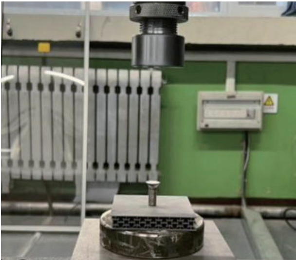
图5 夹芯板压缩穿透实验平台
