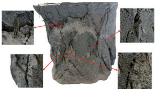
图 3 BFRFC 代表性试样的破坏界面 Fig. 3 Damage interface of representative specimen of BFRFC
