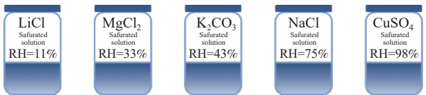
图 3 相对湿度 (RH) 标准瓶 Fig. 3 Relative humidity (RH) standard bottles
