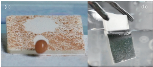
图4 (a) EP-PDMS-PVDF-SiO 2 涂层的弹跳和自清洁性能; (b) EP-PDMS-PVDF-SiO 2 涂层银镜反射现象
