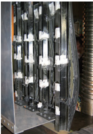
图 14 Y-3 型壁板轴压破坏模式 Fig. 14 Failure mode of panel Y-3
