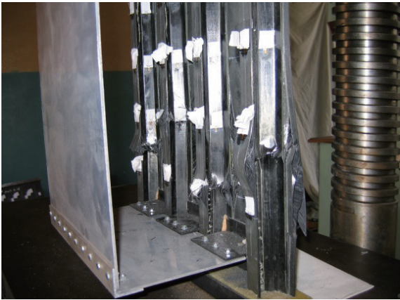
图 10 Y-1 型壁板轴压破坏模式
