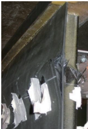
图 18 J-2 型壁板轴压破坏模式 Fig. 18 Failure mode of panel J-2
