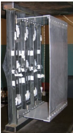
图 16 J-1 型壁板轴压破坏模式 Fig. 16 Failure mode of panel J-1
