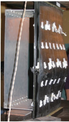
图 12 Y-2 型壁板轴压破坏模式
