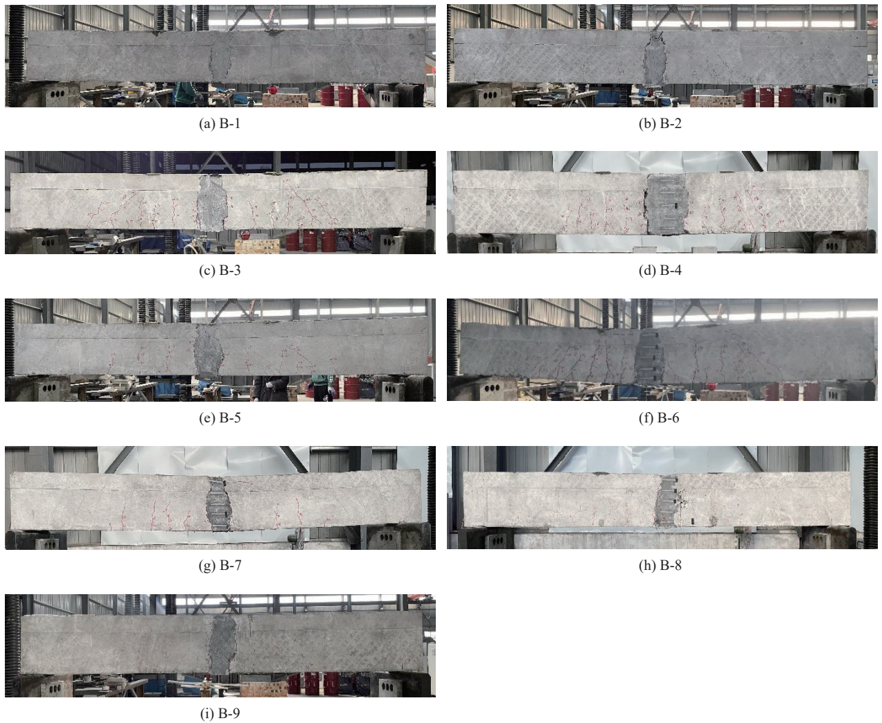
图8 UHPC-高强钢筋梁式搭接试件破坏示意图
