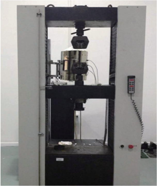
图 20 实验使用的 WDW-E100D 微机控制电子万能试验机 Fig. 20 WDW-E100D microcomputer-controlled electronic universal testing machine used in the experiment
