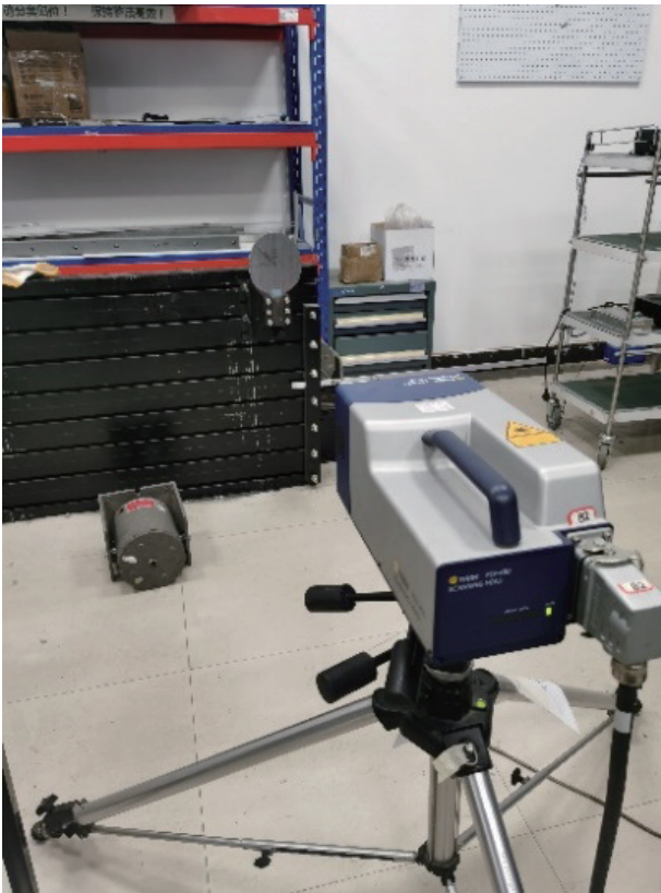
图4 非接触式模态测试设备
