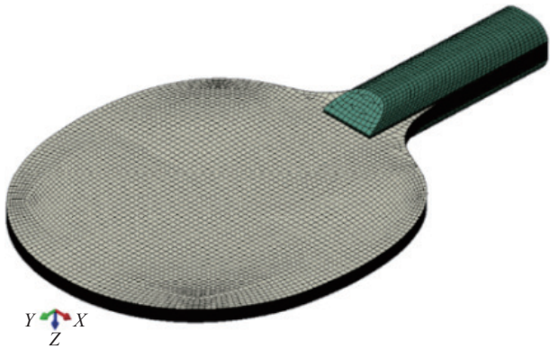
图3 乒乓球拍底板的有限元模型
