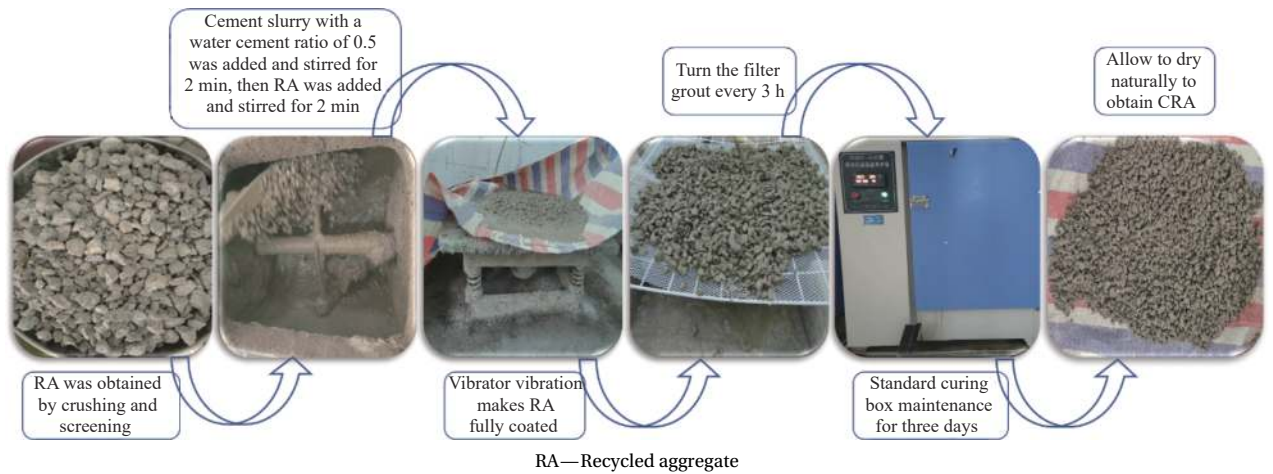
图1 水泥净浆改性再生骨料 (CRA) 制作流程及其形态
