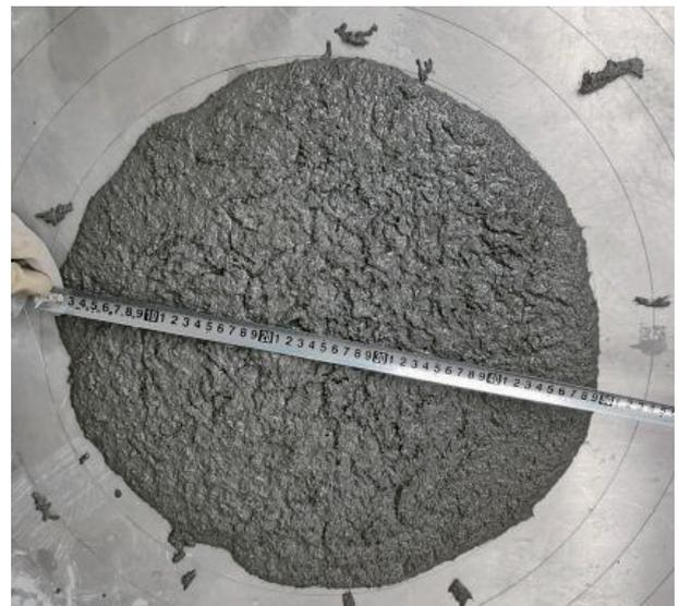
图1 超高性能水泥基复合材料 (UHPFRC) 的扩展度测试
