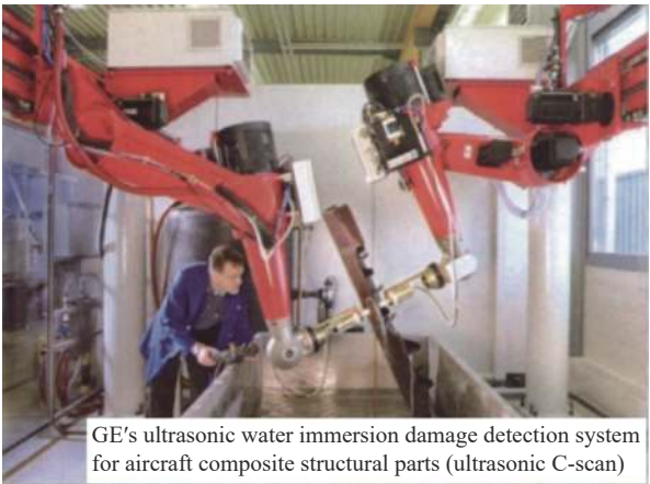
图8 超声C扫描检测系统 [24] Fig. 8 Ultrasonic C-scan detection system [24]
