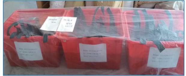
图5 CFRP-混凝土试件酸雨侵蚀模拟环境
