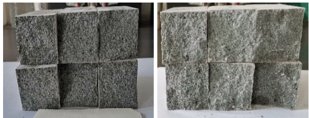
图 12 砂浆试件抗折试验图：(a) 基准砂浆试件破坏断面；(b) 相变微胶囊储能砂浆试件破坏断面
