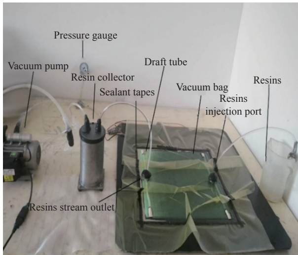
图2 碳/玻混杂叶片试样的成型系统
