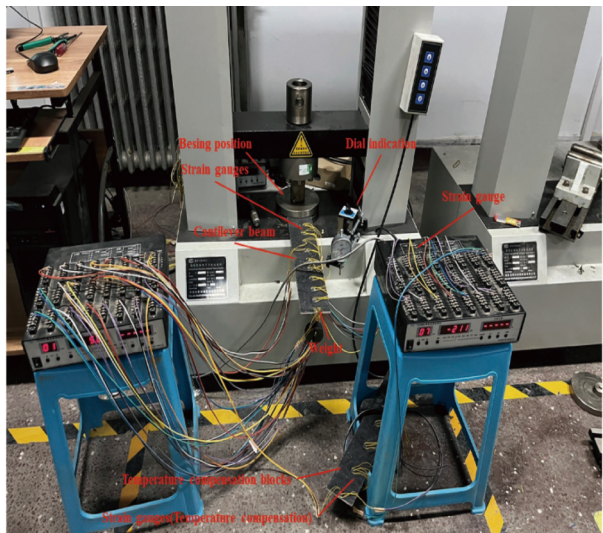
图 7 碳/玻混杂叶片试样弯扭耦合实验
