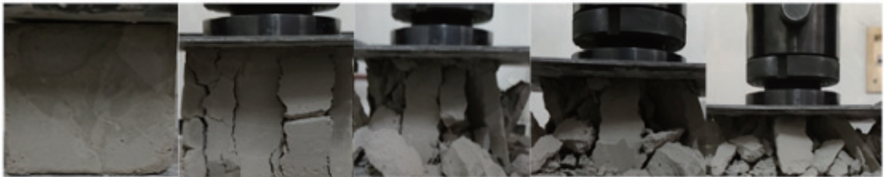
图 4 700\text{ kg/m}^3 的泡沫混凝土立方体试块准静态压缩变形破坏模式
