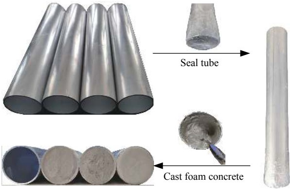
图 2 填充泡沫混凝土铝管试件制作过程
