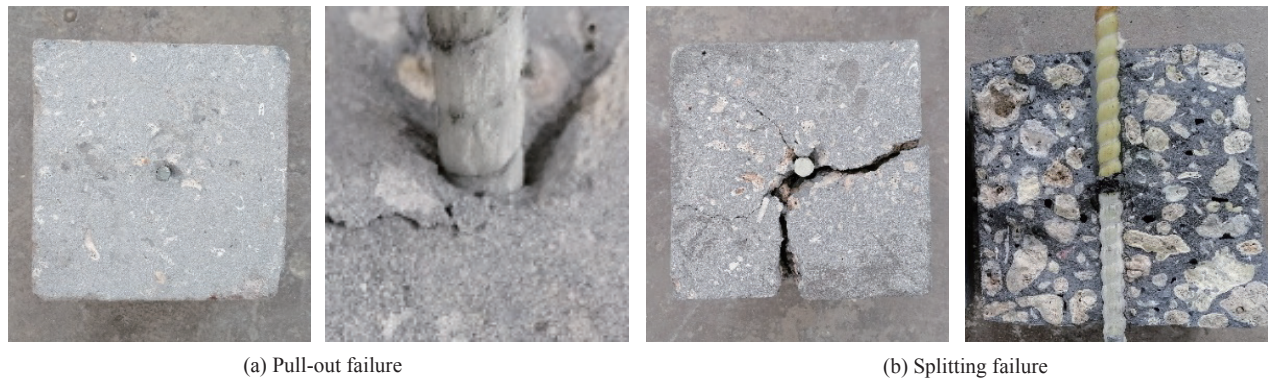
图 8 GFRP 筋珊瑚混凝土试件粘结破坏形态
