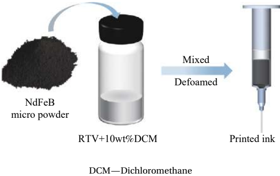
图1 NdFeB-室温固化橡胶(NdFeB-RTV)复合材料前驱体墨水的制备流程
