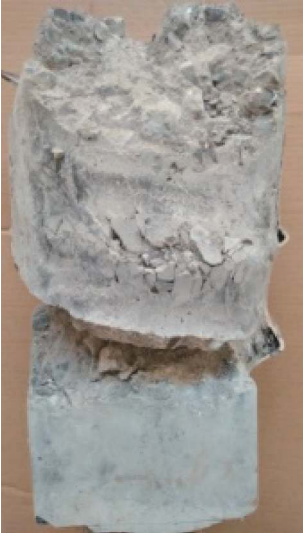
图3 核心 BFRRC 破坏形态
