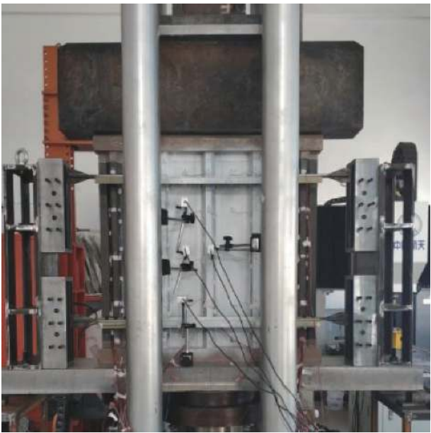
图3 复合材料帽形加筋板轴压试验照片
