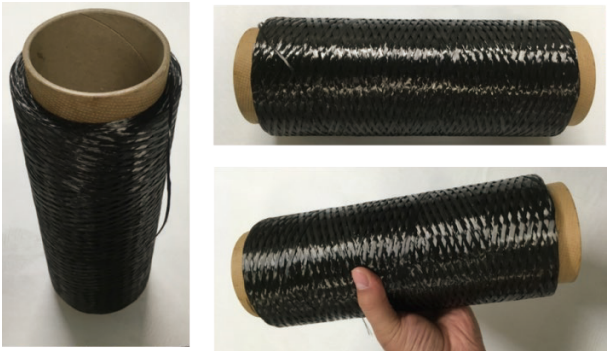
图 16 长度 2 000 m 的自制 T700/H230 预浸纱 Fig. 16 Actual picture of the T700/HY230 prepreg yarn with a length of 2 000 m
