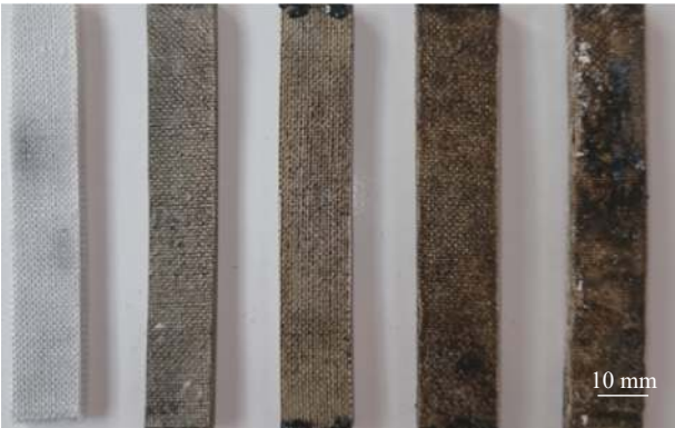
图 8 1 200 °C 高温处理 20 min 后不同 AM 含量的 HSF-AM/BPR 可陶瓷化复合材料的表面形貌变化 (AM 含量从左向右依次是 0wt%、20wt%、30wt%、40wt% 和 50wt%)
