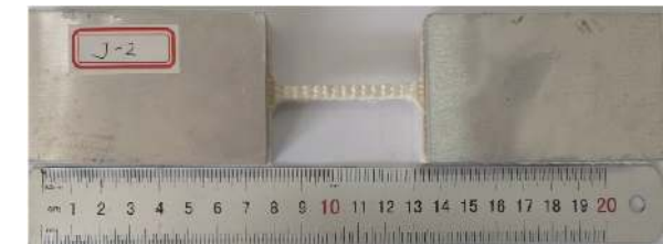
图 7 三维角联锁机织 UHWMPE 纤维/聚氨酯复合材料试件设计方案及经向拉伸试件
