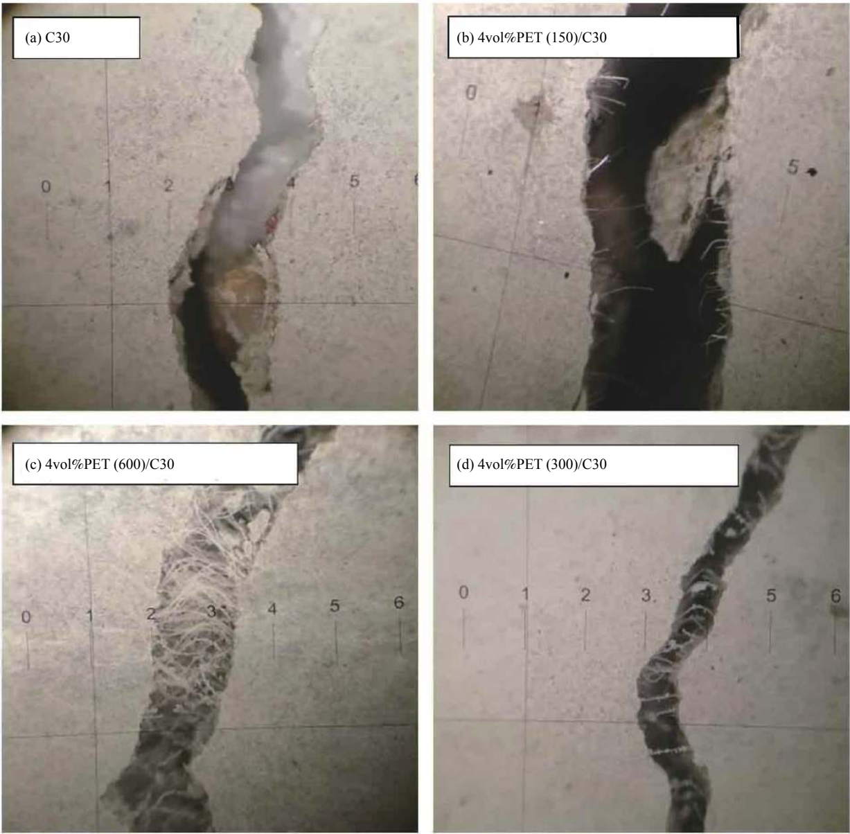
图3 PET 纤维/混凝土断面细观图 Fig. 3 PET fiber/concrete cross-section micrograph
