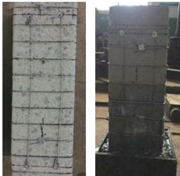
图 1 HSE 约束素混凝土试件 Fig. 1 HSE confined concrete specimens
