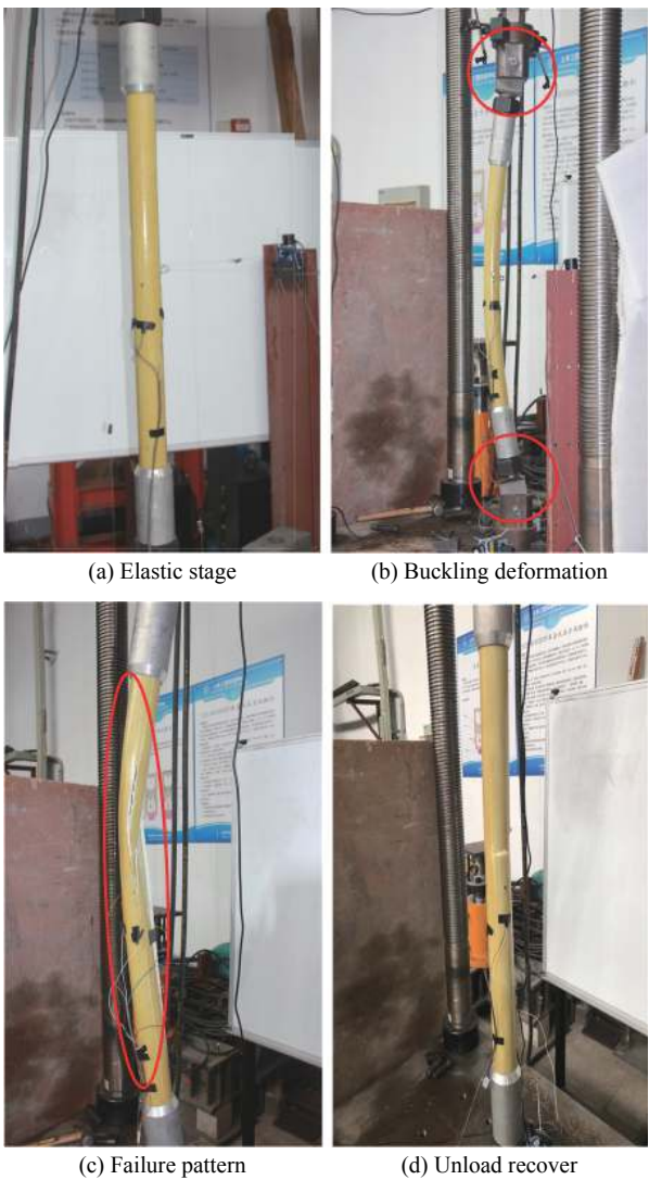
图 4 GFRP 管轴压试验过程与破坏形态
