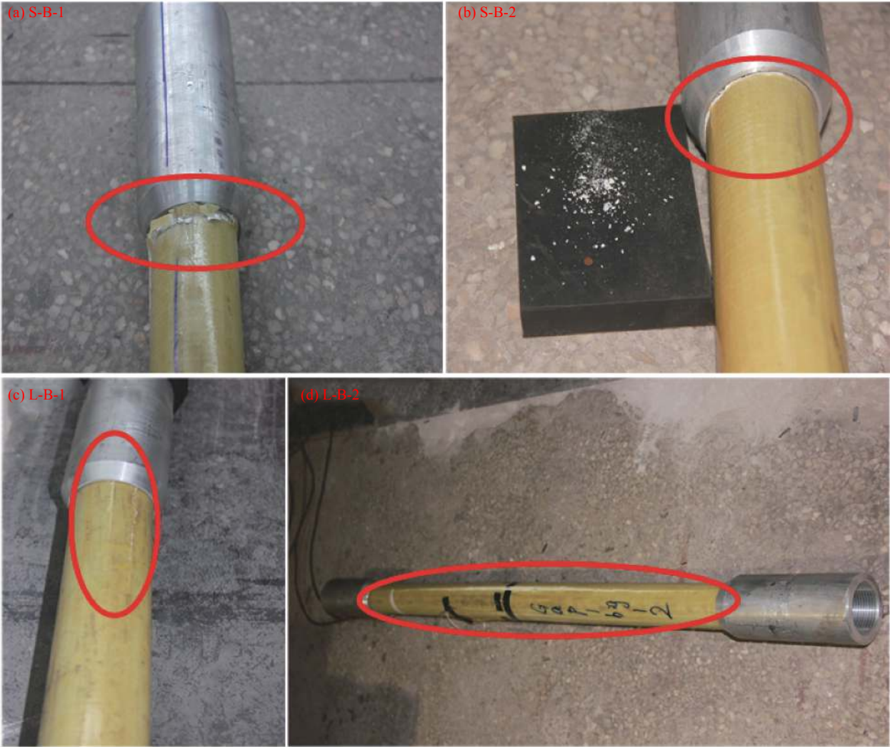
图 9 内核 GFRP 管破坏形态 Fig. 9 Failure pattern of core GFRP tubes
