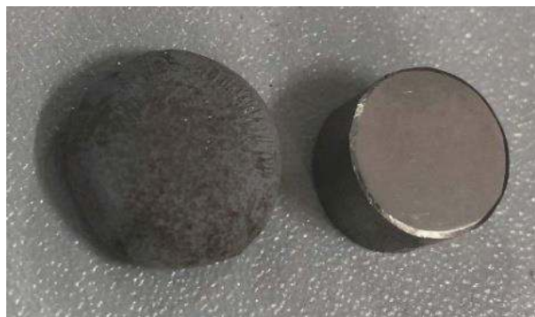
图3 \text{TiC}_p 质量分数为 15wt%、烧结温度分别为 1 240℃ 和 1 255℃ 的 \text{TiC}_p /HCCI 试样
