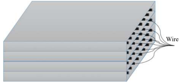
图 1 埋入形状记忆合金 (SMA) 的复合材料示意图
