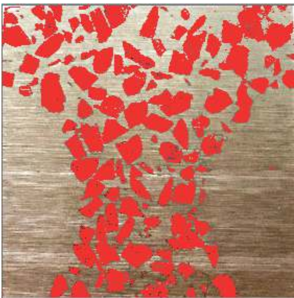
图 6 ZTA p /HCCI 复合材料磨损试样图像处理
