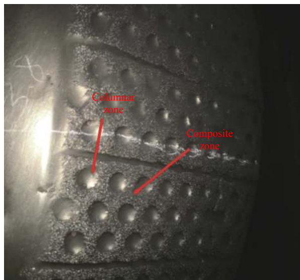
图9 ZTA p /HCCI 复合磨辊表面磨损形貌
