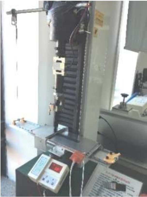
图 4 剥离试验装置 Fig. 4 Experimental set-up for peeling test
