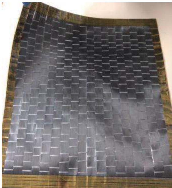
图2 CF/PEEK 复合材料单向织物
