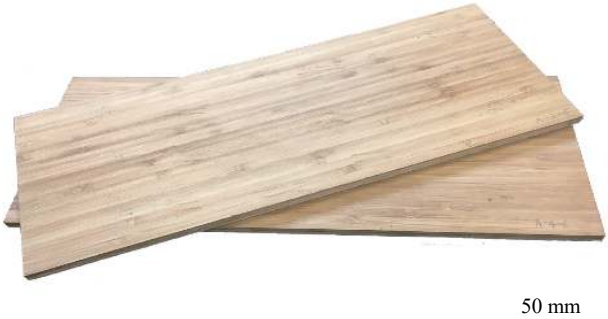
图2 两种不同面面板厚度的 CFP 木质电热复合材料试样
