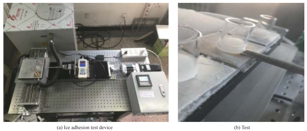
图 3 冰结合力测试装置及测试试验照片 Fig. 3 Photographs of ice adhesion test device and test
