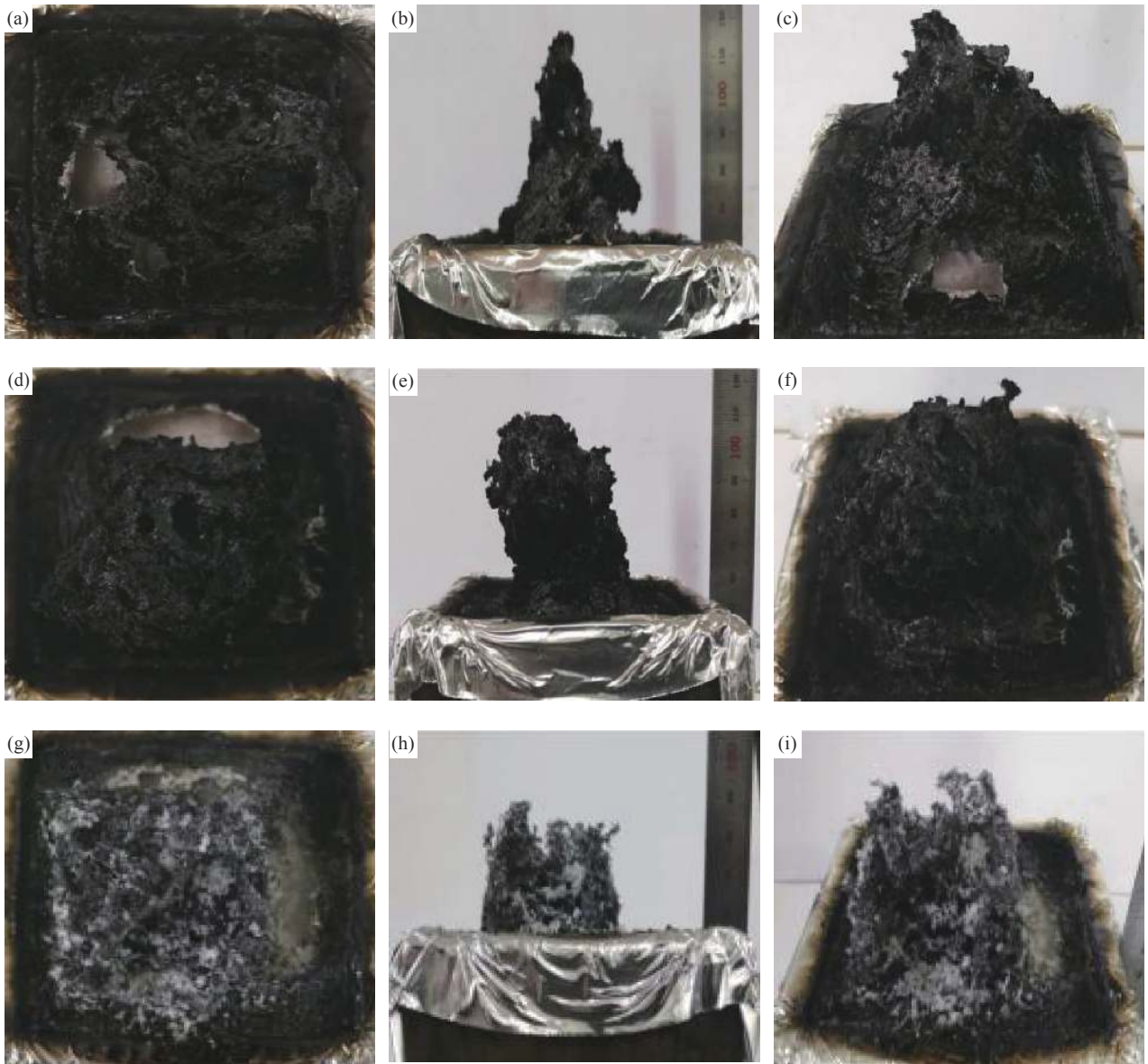
图 2 10RDP/(PC-ABS)((a)~(c))、1SiO 2 -10RDP/(PC-ABS)((d)~(f)) 和 1SiO 2 /(PC-ABS)((g)~(i)) 阻燃合金的燃烧残炭形貌
