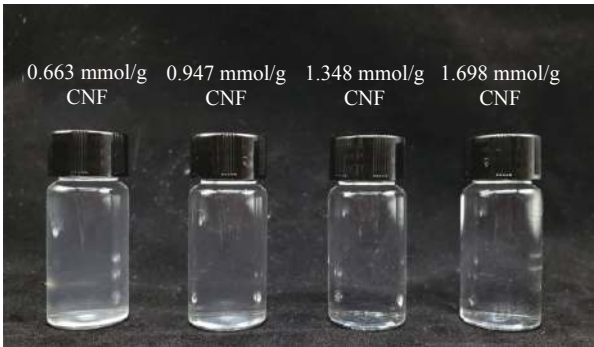
图 3 不同羧基含量的 CNF 分散液 (1 mg/mL) 的光学照片 Fig. 3 Optical photograph of CNF dispersions (1 mg/mL) with different carboxyl contents
