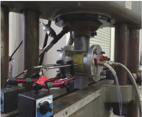
图 2 荷载作用下的渗透实验
