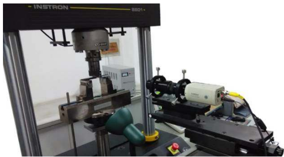
图5 II 型疲劳分层扩展试验系统及裂纹观测装置
