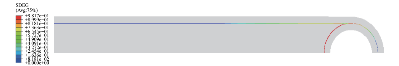
图 15 碳纤维/环氧树脂复合材料缠绕接头胶层最终损伤形式
