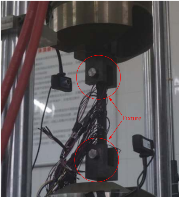
图 2 复合材料缠绕接头试件加载示意图
