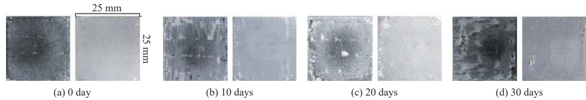
图 10 铝合金-BFRP 复合材料粘接接头剪应力破坏的典型失效断面 (-10℃)
