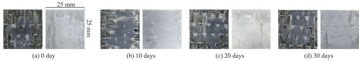
图 11 铝合金-BFRP 复合材料粘接接头拉应力破坏的典型失效断面 (-40℃)
