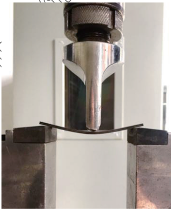
图 5 弯曲试样夹持方式 Fig. 5 Bending specimen clamping method
