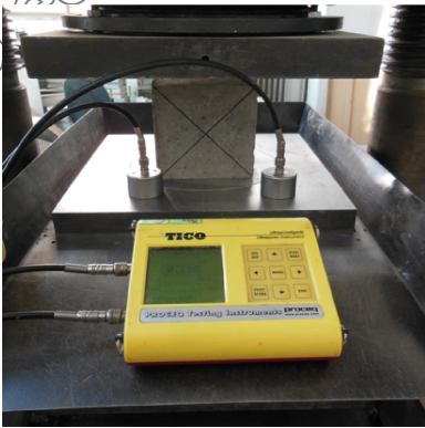
图 5 NC 超声测量装置 Fig. 5 Ultrasonic measurement of NC
