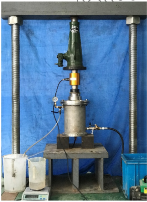
图 3 渗透试验装置 Fig. 3 Permeation equipment
