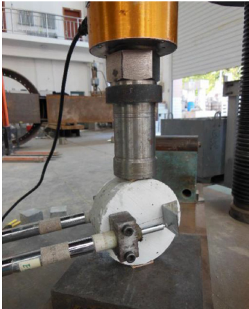
图 2 圆盘劈裂试验装置 Fig. 2 Splitting test setup
