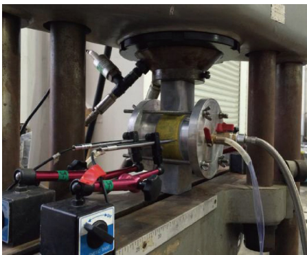
图 2 荷载下渗透实验装置 Fig. 2 Permeability test setup under loading
