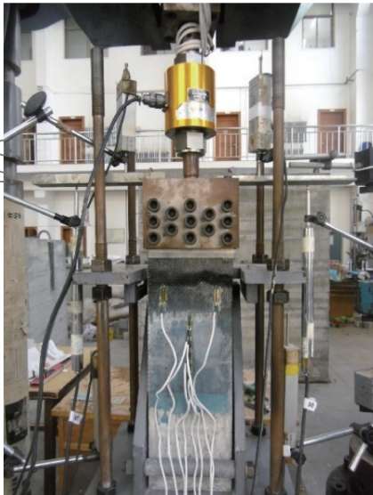
图 3 CFRP-混凝土单剪试验装置
